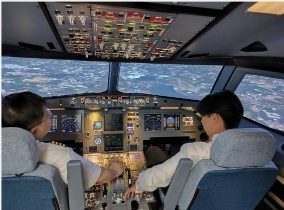
朝陽科大斥資新台幣千萬元打造A320模擬機，駕駛艙設備皆仿真機製作，可擬真呈現駕駛艙外景物。
